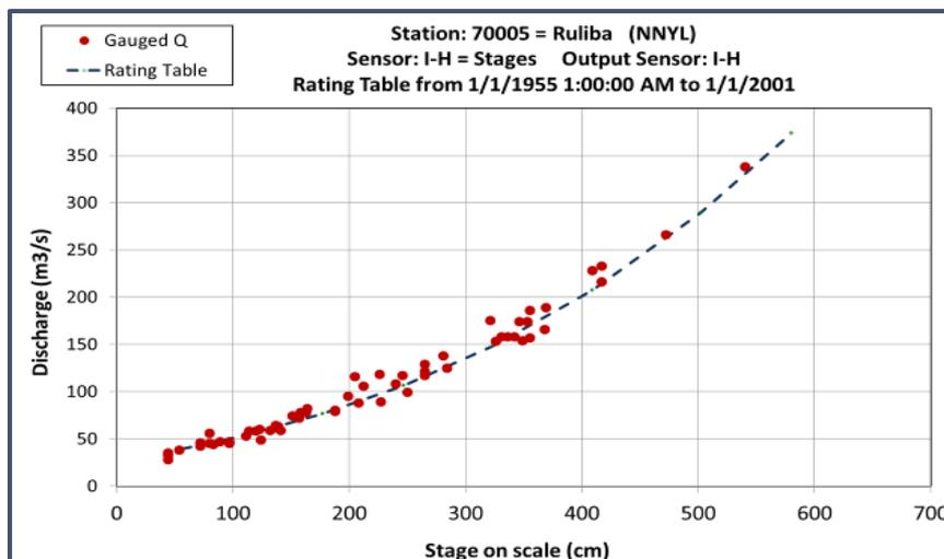
FIGURE 6 THE RATING CURVE OF NYABARONGO RIVER AT RULIBA STATION
