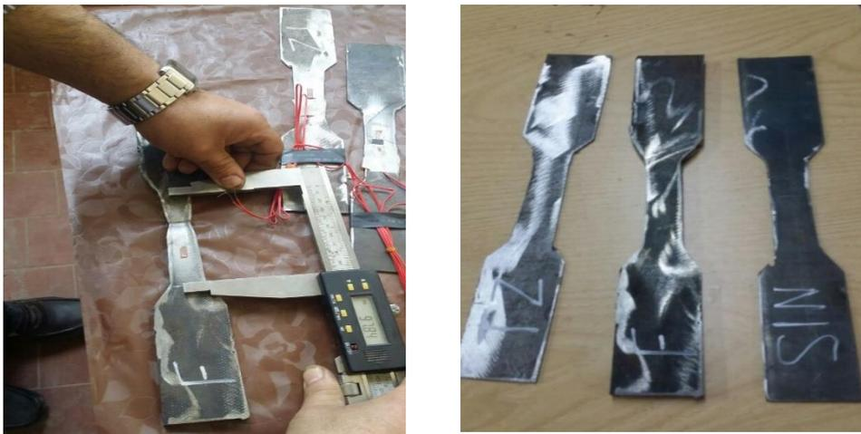
**Fig. 4. Tensile coupon specimens**
